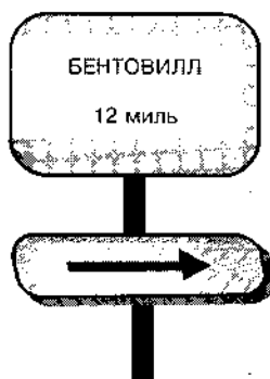
Рисунок 6.2. Дорожный указатель как пример направляющей и подтверждающей информации
